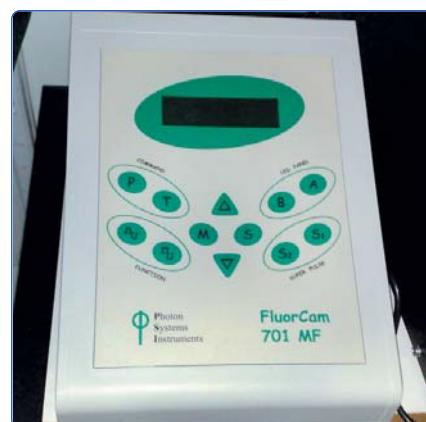
Fluorymetr do pomiarów fluorescencji chlorofilu in vivo z wyposażeniem do obrazowania (PAM)
