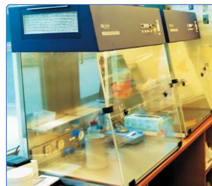
Komora do pracy z RNA i DNA z oczyszczaniem powietrza poprzez filtrację HEPA oraz lampy UV, UVP, PCR workstation
